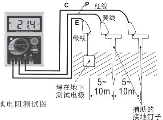
b. 地电压测试: 请先将量程选择开关换至接地电压 (“E.V” ) 档, 地电压将会自动显示, 确信地电压≤10V, 当地电压>10V, 会导致额外错误的结果, 为避免这种情况, 可将相关电气设备关闭, 测试电压降低后再进行地电阻测试。
