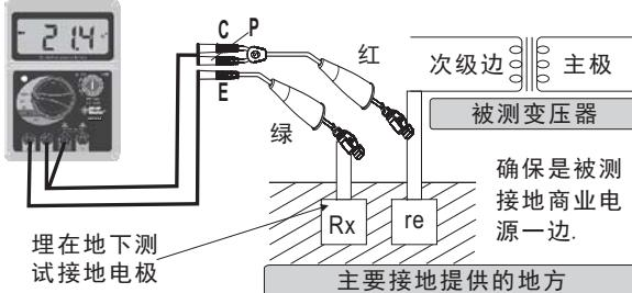
当采用此方法时，实际上P和C端子已经短接起来。此简单法也可用于测量电压，只要将绿色测试线改插V端口即可。
