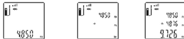
按  $\ominus$  键，开机，再次按下启动激光。对准目标再次按该键，开始测量，测量的第一个数据立即显示在显示屏上。
